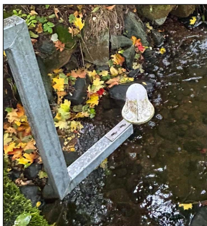
Ein Sensor misst den Pegel eines kleinen Baches. Symbolfoto: Ralf März
