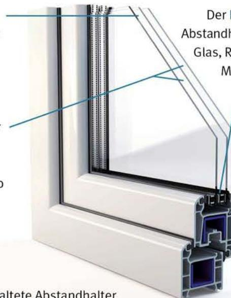
Der **Randverbund** besteht aus Abstandhalter, Dichtungsmaterial, Glas, Rahmen und versiegelt die Mehrscheibenkonstruktion hermetisch gegen das Entweichen von Füllgas.
